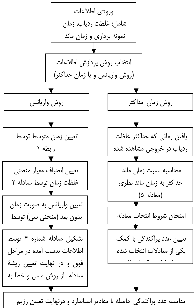
شکل ۳- نمایی از روش برنامه نویسی برای تعیین عدد پراکندگی با کمک اطلاعات حاصل از آزمون ردیاب
