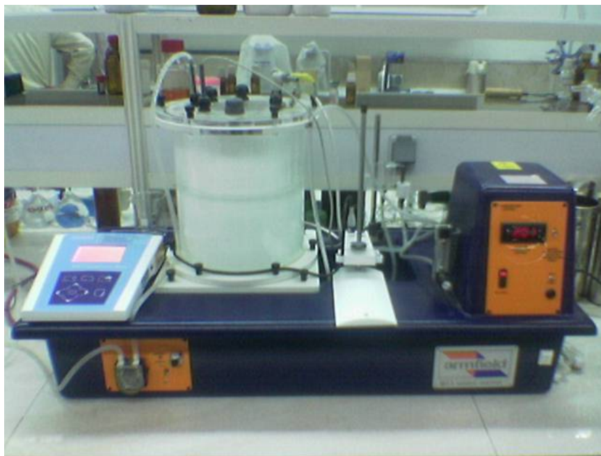
شکل ۲- راکتور بیولوژیکی تحقیقاتی ساخت شرکت آرمفیلد آلمان در حین انجام آزمون ردیاب و با وجود صافی پلاستیکی
